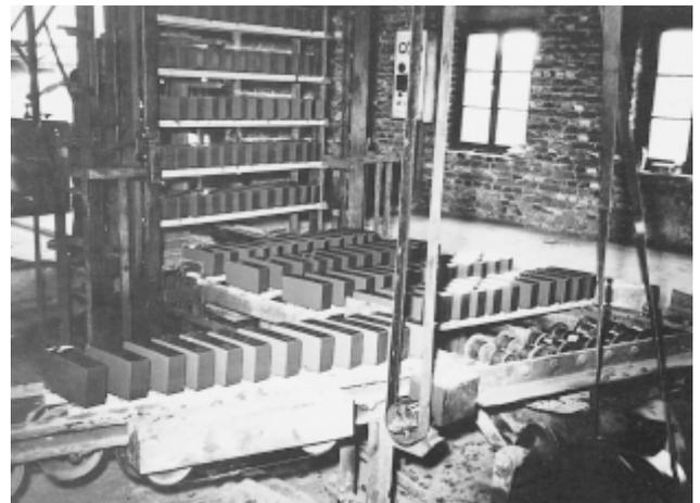
*Die Steinrohlinge verlassen die Strangpresse und gehen über Absetzwagen zur Trocknung, Ziegelei Vallée*
